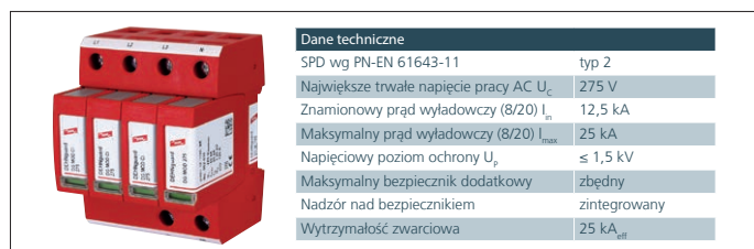
Rys. 7. DEHNguard® MCI – modułowy ogranicznik przepięć typu 2 z wbudowanym bezpiecznikiem.
