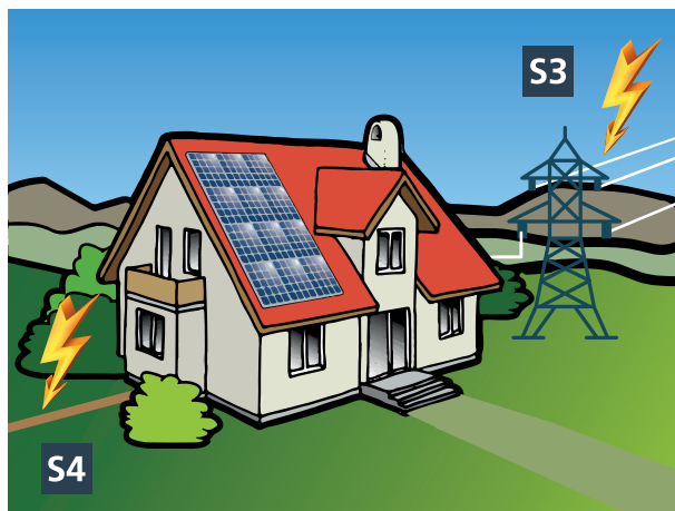
Rys. 2. Możliwe zagrożenie dla instalacji prosumenckiej PV spowodowane wyładowaniem piorunowym: S1 – bezpośrednie wyładowanie piorunowe w obiekt, S2 – wyładowanie obok obiektu, S3 – wyładowanie w linii przyłączone do obiektu, S4 – wyładowanie w pobliżu linii przyłączonych do obiektu
