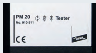
Można badać działanie iskierników, warystorów oraz diody Zenera
