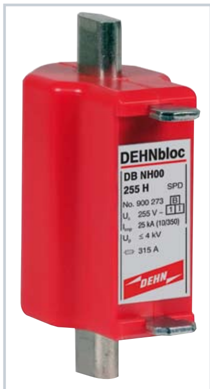
Rys. 1. DEHNbloc NH00 255 H - nowy ogranicznik jednopolowy
