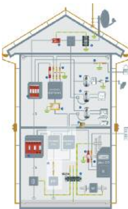
Rys. 4. Ochrona przepięciowa dla systemu pieca z układem automatyki: 1. Ogranicznik przepięć typu 1 - 230/400V AC. 2 Ogranicznik przepięć typu 3 - 230 V AC. 4. Ogranicznik przepięć w linii transmisji sygnałów. 5. Główna szyna wyrównawcza.
