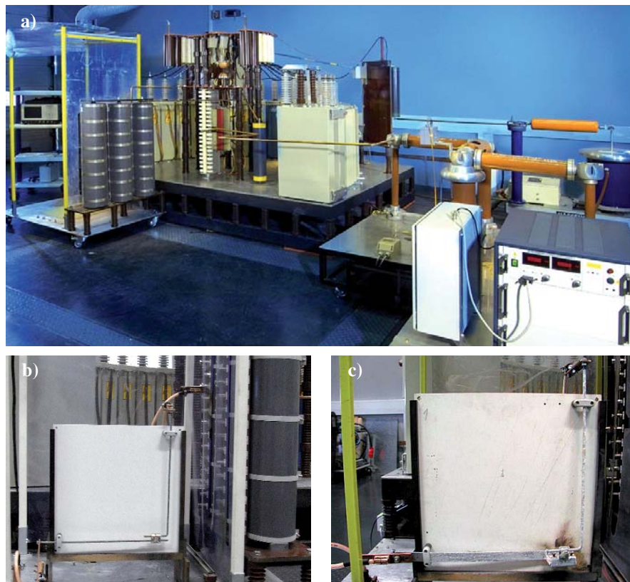
Rys. 3. Badanie elementów urządzenia piorunochronnego: a – widok generatora stosowanego do prób, b – element przed badaniem, c – element po badaniu
