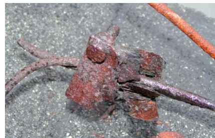
Rys. 1. Zaniedbane elementy instalacji odgromowej na dachach obiekt6w budowlanych
