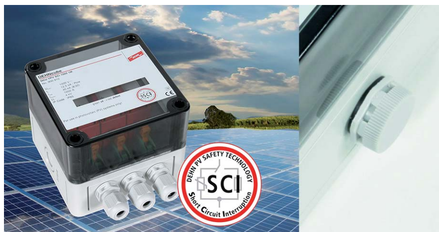
Rys. 2. Ogranicznik DEHNcube w obudowie IP65. Obudowa wyposażona jest w układ wyrównania ciśnienia (po prawej) zapobiegający kondensacji wody wewnątrz
