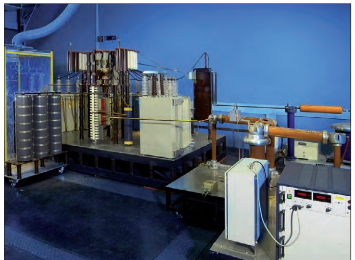
Fot. 2. Ogólny widok generatora stosowanego do badań elementów LPS
