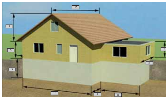
Rys. 7. Model budynku wraz z wymiarami geometrycznymi
