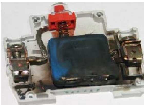
Rys. 7.2. Fotografia uszkodzonego SPD typu Moeller SPB-12/280 (I + II), przy udarze 12,5 kA (10/350)
