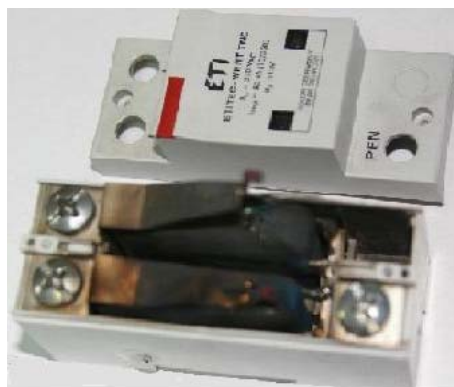
Rys. 5.2. Fotografia uszkodzonego SPD typu ETITEC – WENT TNC (I + II), przy udarze 12,5 kA (10/350)
