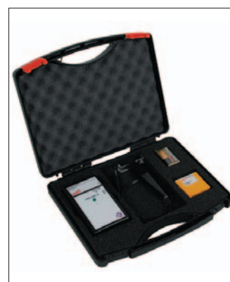
Fot. 5 Zestaw pomiarowy do kontroli ograniczników przepięć BLITZDUCTOR CT LC
