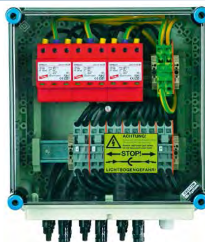
Rys. 5. Ogranicznik przepięć typu 2 do ochrony obwodów prądu stałego – DEHNguard® YPV SCI – kompakt (wygląd oraz przykład montażu w skrzynce przyłączeniowej paneli PV – ochrona trzech stringów)
