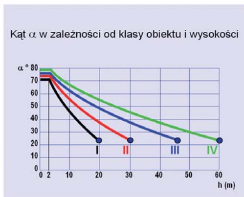
Rys. 2. Zmiany kąta osłonowego w funkcji wysokości zwodu i oraz klasy LPS
