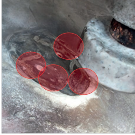
Rys. 6. Wytopienia receptora spowodowane przepływem ładunku 3Q w czasie 500 ms
